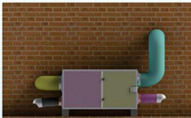
**4** Sambungan Pipa: Dimensi Pipa untuk udara pemrosesan dan udara reaktivasi harus sejalan dengan nilai yang di rekomendasikan ISO 7807. Pipa harus di hubungkan dengan bagian sambungan pada flange, sedangkan baut ulir dibatasi di dalam 20mm. Saat menhubungkan pipa input dan out, beberapa catatan seperti berikut:
